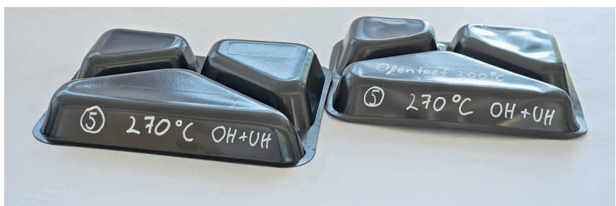
Bild 7. Aus Folie 5 produzierte rPET-C-Schalen vor und nach dem Ofenversuch bei OHZ/UHZ 270 °C (© Illig)
