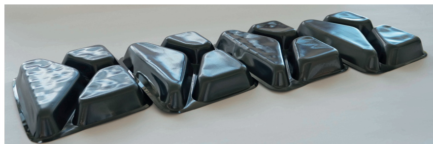
Bild 6. Ofenversuche bei 200 °C für 20 Minuten: rC-PET-Schalen (v.l.n.r. Rolle 2, 3, 4, 5); oben mit 250°C Ober- und Unterheizung, unten mit 270 °C (© Illig)
